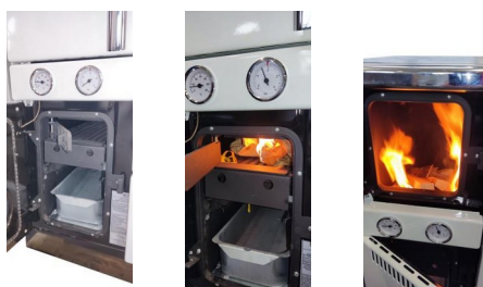
Joonis 12. Resti tõke, alumine ja ülemine restiasend.
