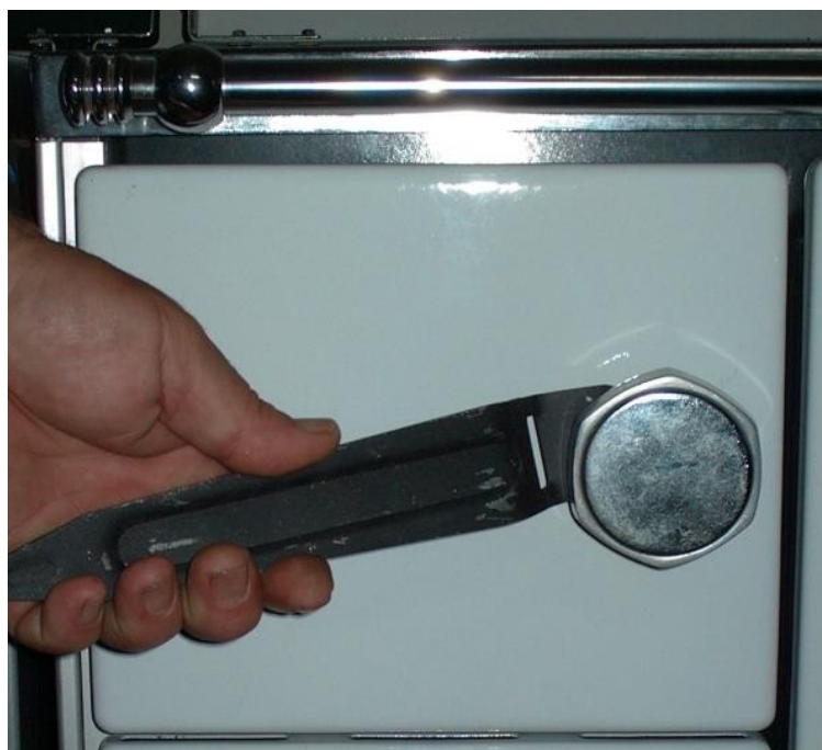
Joonis 12. Koldeukse avamine tööriistaga.
