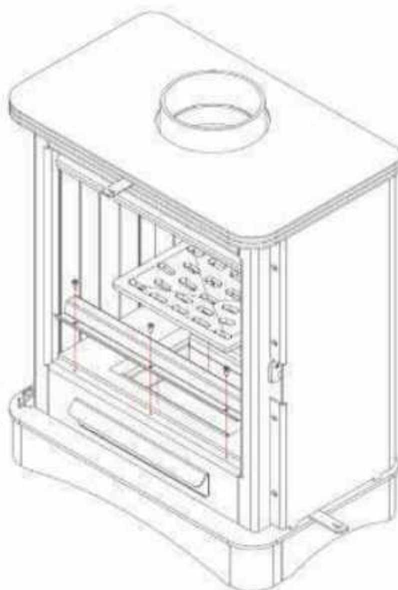
37. Kolejność demontażu oraz wymiany deflektora i wyłożenia accumote – VEGA The procedure for the baffle and Termotec lining disassembly and replacement – VEGA
